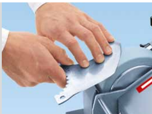
Démorfilage de cutters sur meule à eau
