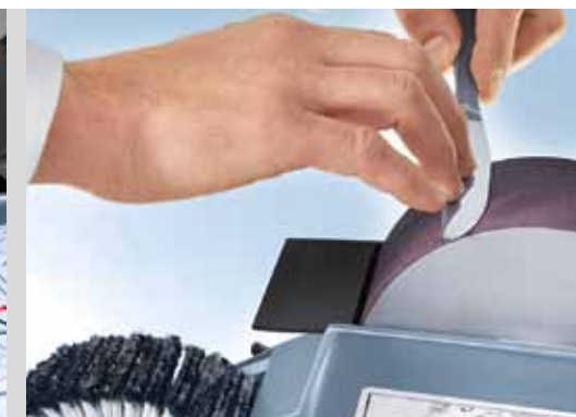
Meule de profilage de denture sur couteaux de table et brosse à lamelles de polissage
