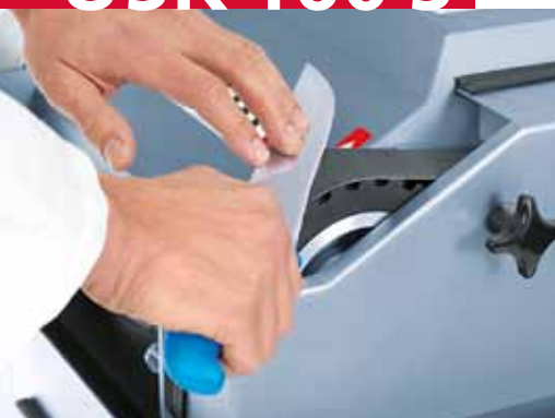
Affûtage de couteaux manuels sur bande abrasive à eau
