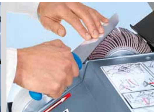
Affûtage de couteaux manuels sur meule abrasive à lamelles et démorfilage sur meule de finition à eau
